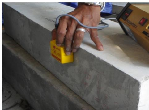
Gambar 3. *Set Up* pemetaan tulangan dalam beton
